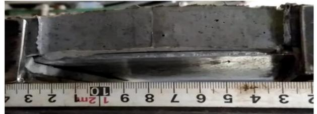
写真2 輸入溶剤の側面の状況 (年変化伸縮試験 16 回終了時)
