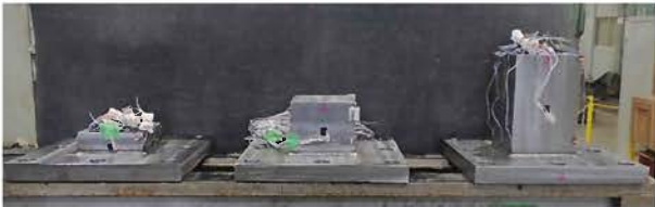
(a) ケース 1 (b) ケース 2 (c) ケース 3 図 1 すみ肉溶接試験体の写真
