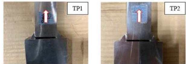
図 3-1 加力直角方向溶接試験体試験結果
