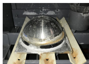
写真-1 複合サイクル試験後試験体
