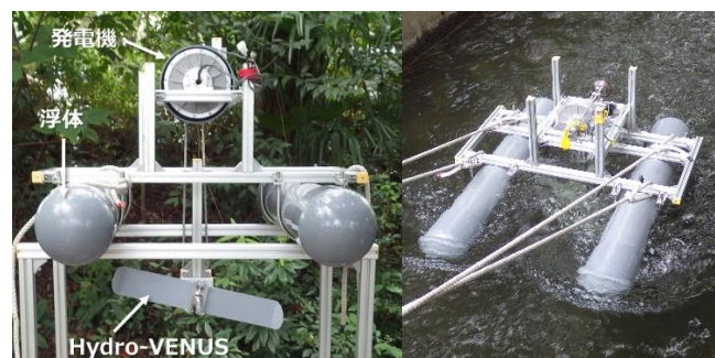
図5 浮体式 Hydro-VENUS 発電装置
