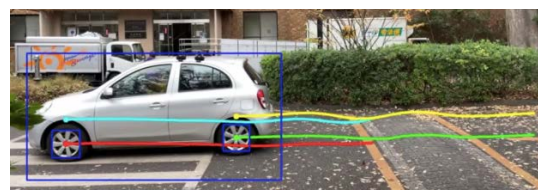
図-1 車両の代表点のトラッキングのイメージ
