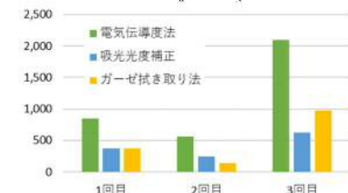
図-2 試験片における \text{Cl}^- 量の比較
