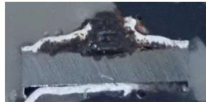
写真-2 クロスカット鋼板の切断面
