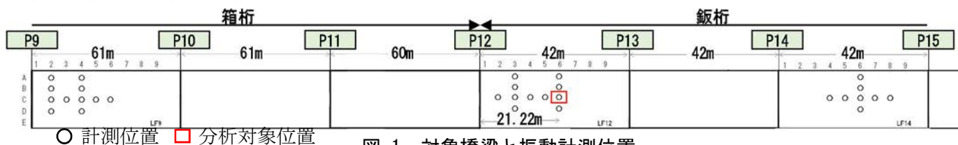
図-1 対象橋梁と振動計測位置
