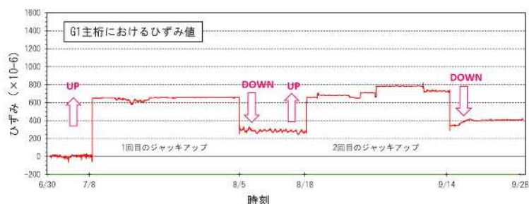
図-3. G1桁におけるひずみ計測値
