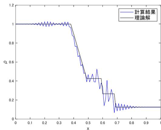
図-3 Lagrange 基底を用いた Euler 方程式の計算結果
