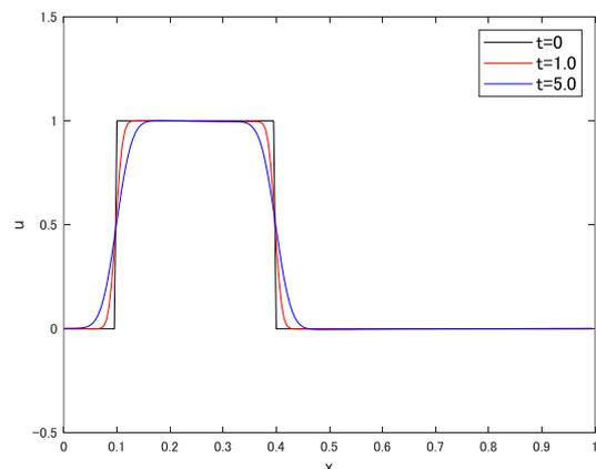
図-2 Hermite 基底を用いた移流方程式の数値計算
