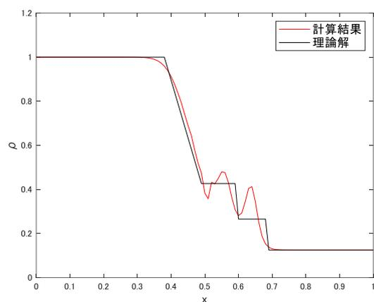
図-4 Hermite 基底を用いた Euler 方程式の計算結果
