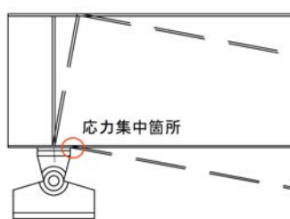
写真1 鋼製支承の腐食 図1 回転不良のイメージ図
