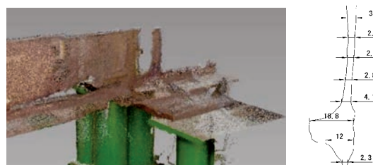
図-2 FARO の点群データ(左)と断面図(右)
