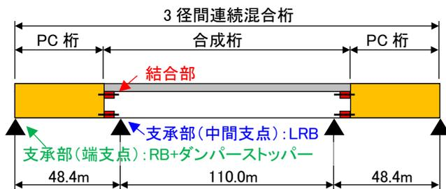
図-1. 混合桁のイメージ図
