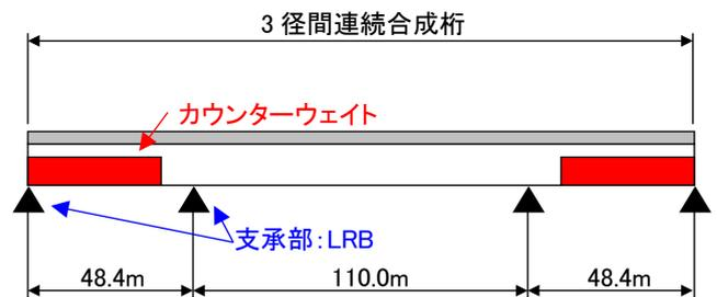
図-2. 合成桁のイメージ図
