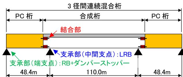
図-2. 混合構造のイメージ図
