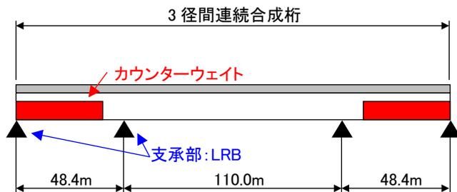
図-1. 合成構造のイメージ図
