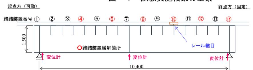
図-2 締結装置緩解箇所と変位計設置箇所
