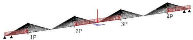
図-2 4主塔5径間モデル
