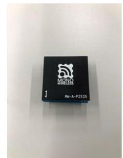
図-1 加速度センサー
