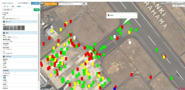
図－1 損傷や補修箇所の位置（PC画面）
