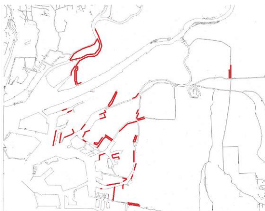
図-2 対象地域の堤防沈下箇所
