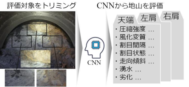
図 1 CNN による切羽性状評価の流れ
