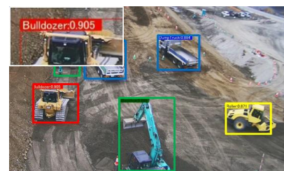
図-4 AI での建機検出結果
