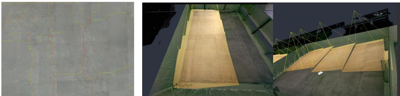
コンクリートのひび割れ自動抽出と3次元点群データ上への重畳
