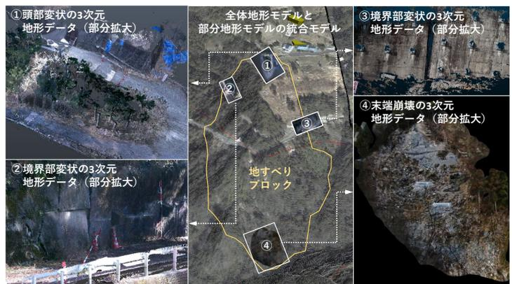
図2 3次元地形モデルを用いた現地調査結果の整理例
