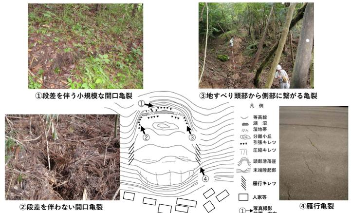
図1 地形図と写真を用いた現地調査結果の整理例
