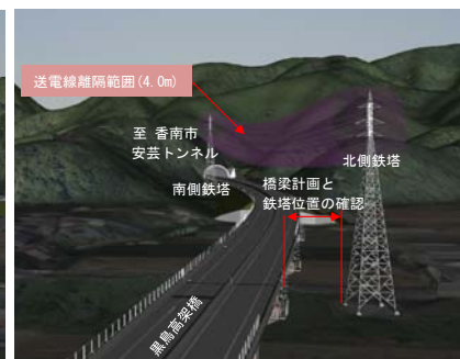
図-4 橋脚との離隔の照査
