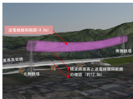
図-3 送電線離隔の照査
