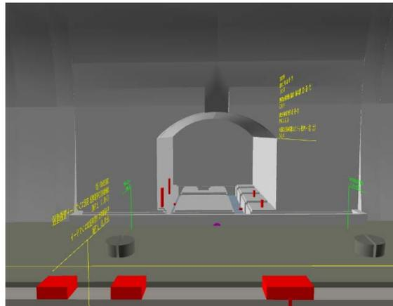
図-2 箱抜き視点のイメージ
