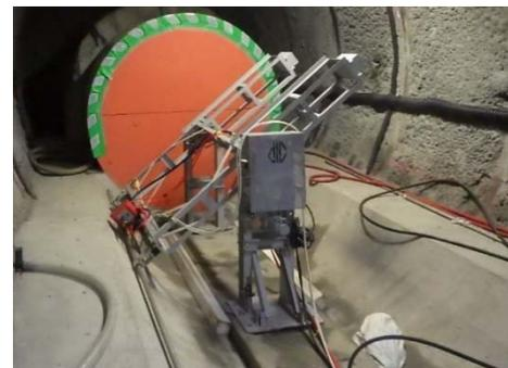
図 2 振り子式除去装置
