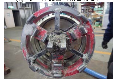
(b) オーガ断面 図2 アタッチメント式オーガ
