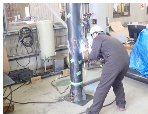
写真-2 施工手順確認試験（溶接）
