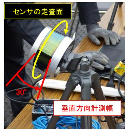
図-2 3次元リアルタイム計測器（VLP-16）の計測範囲
