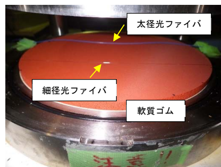
図-6 軟質ゴム上への光ファイバセンサーの配置
