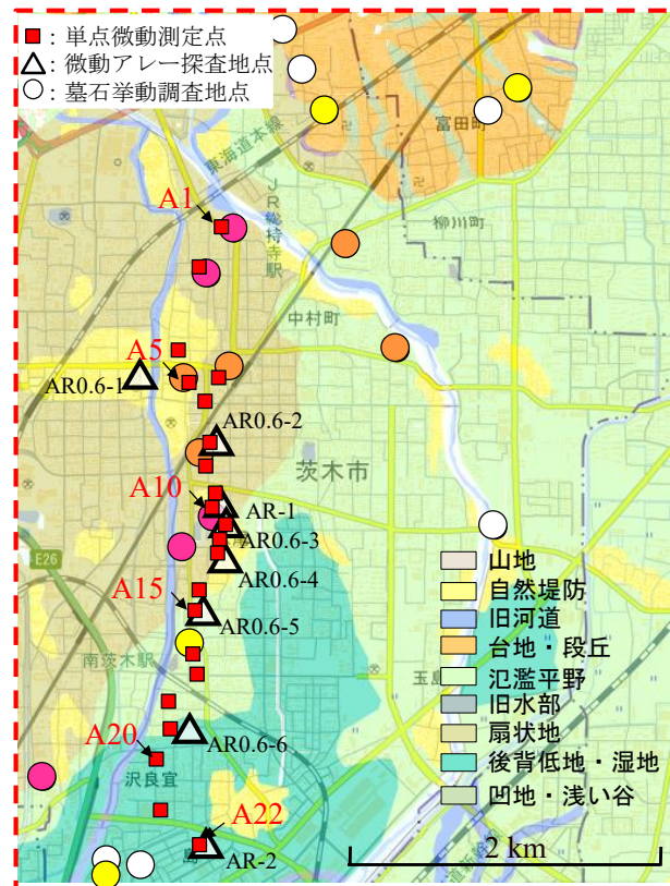
図-2 NIED推定震度分布と墓石震度の分布および微動探査地点
