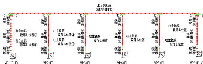
図-2 既設橋の非線形動的解析モデル図
