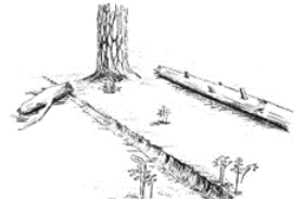
立木に当り折損 図1 埋木の飛び跳ね 3)
