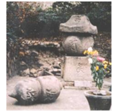
(a) 庭からの跳び笠石 (b) 敦盛塚頭部の落下 図5 兵庫県南部地震(1995,M7.3)での跳び石現象 2)
