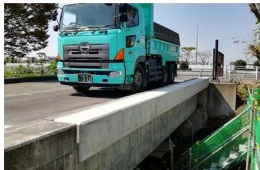
写真-1 車両載荷試験状況
