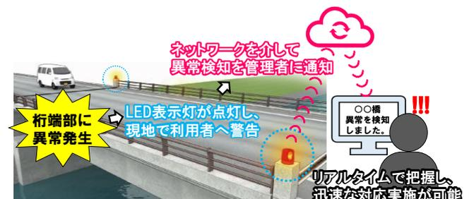
図-2 モニタリングシステムのイメージ
