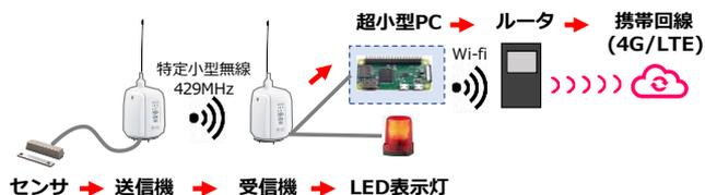
図-3 モニタリングシステムの構成
