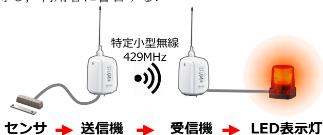
図-5 センサから LED 表示灯までの通信経路
