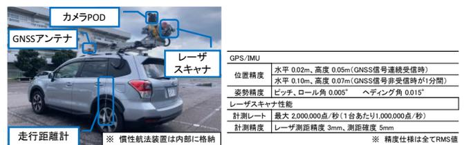
図-2 Trimble MX9 のセンサ構成とシステム仕様<sup>3)</sup>
