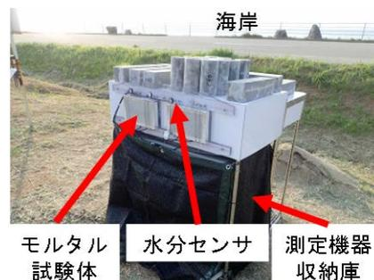
図-3 供試体・測定機器設置状況
