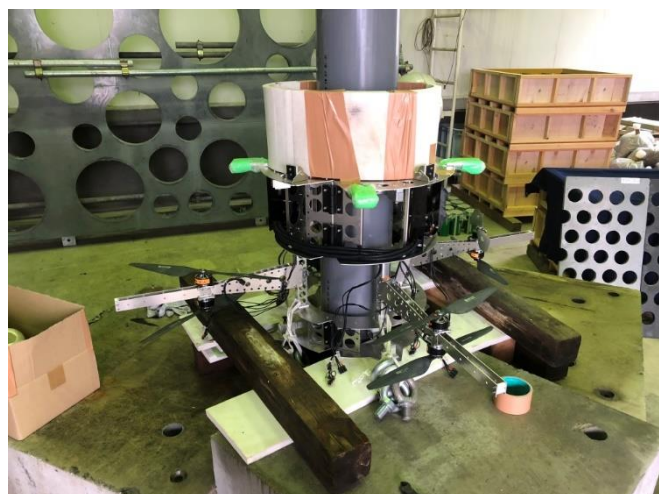
写真-2 昇降ユニットの揚重実験
