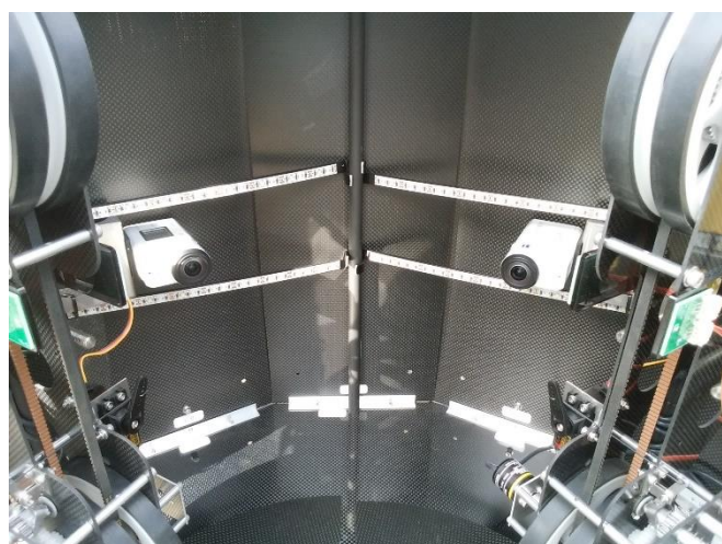
写真-1 撮影ユニット内部とカメラ配置
