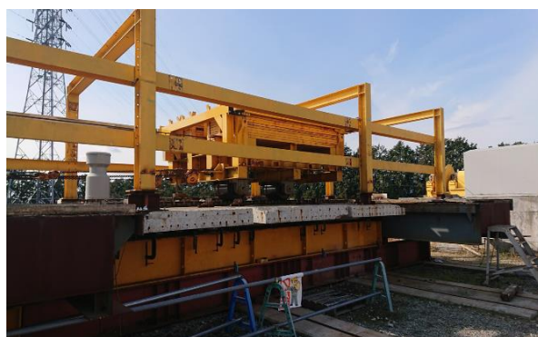
図1 輪荷重載荷試験機
