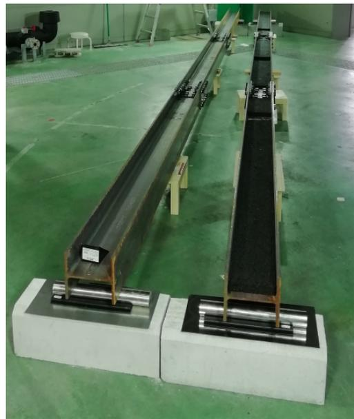
図3 製作した模擬橋梁
