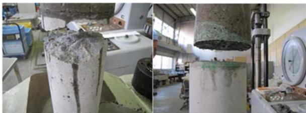
写真-1 コンクリートの破断 写真-2 界面の破壊
