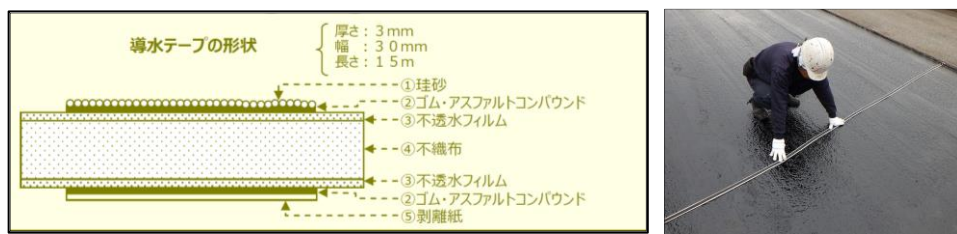
図-1 導水テープの構造断面と現場での設置状況
