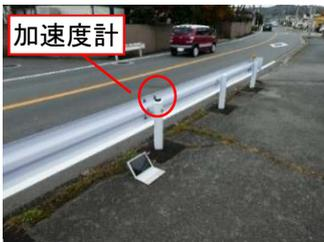
写真 5-2 加速度計設置状況
