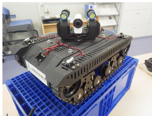
写真-2 磁石式点検ロボット「やもりん」
