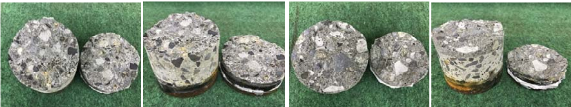
(1) 超速硬コンクリートCPJ (2) ラテックス改質超速硬コンクリートCPJ-L
