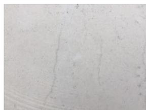
図3 水準Bのひび割れ
