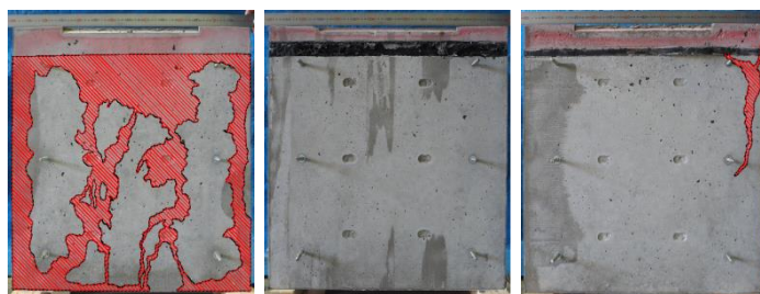
＜A: シール無＞ 浸水面積率: 42% ＜B: 反応接着型＞ 浸水面積率: 0% ＜C: 水膨張ゴム＞ 浸水面積率: 2%
