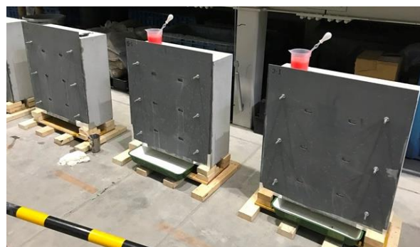
＜A: シール無＞ 排水量: 384ml ＜B: 反応接着型＞ 排水量: 0ml ＜C: 水膨張ゴム＞ 排水量: 0ml
