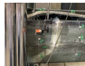
図 5 曲げ載荷実験破壊状況
